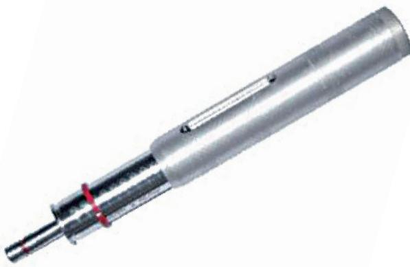
Il penetrometro tascabile è uno strumento che serve a classificare i campioni di suolo secondo la rispettiva resistenza alla compressione. Sulla scala graduata si leggono direttamente i valori della resistenza alla compressione espressa in  $\text{kg}/\text{cm}^2$  oppure in kg.
